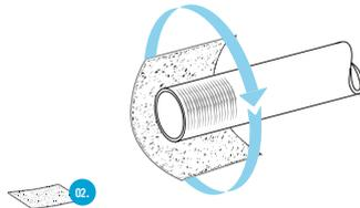
**!** Ermitteln des Rohraußendurchmessers  $\varnothing$  mittels Rohrkenzeichnung oder Messschieber.
