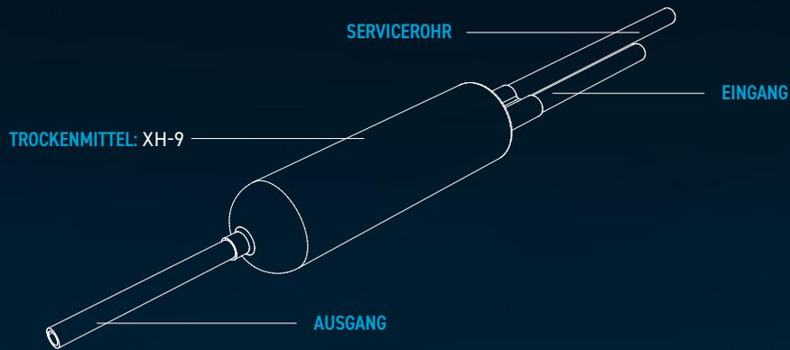
Schützt den Kältekreislauf vor Feuchtigkeit, Säuren und Schmutzpartikeln.
