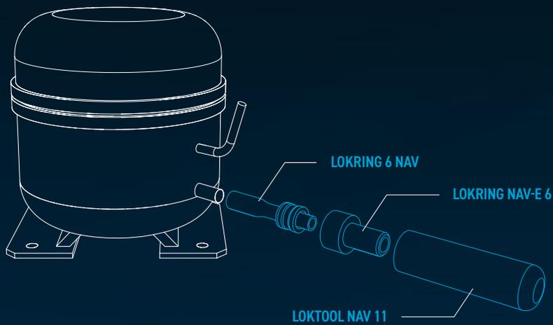
NAV Verbindungen ermöglichen den LOKRING Einsatz bei verkürzten Rohrenden an Kompressoren.
