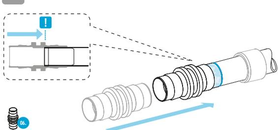
**5** Montagebacken (08) hinter LOKRING (07) und Montagesteg des Stutzens (06) ansetzen. Rohrverbindung verpressen. **!** Einstecktiefe von Rohr und Verbindungsstutzen nicht verändern. Rohrverbindung verpressen, bis LOKRING (07) bündig am Montagesteg des Stutzens (06) anliegt. LOKPREP (05) muss ausgehärtet sein bevor die Verbindung mechanisch belastet werden darf.
