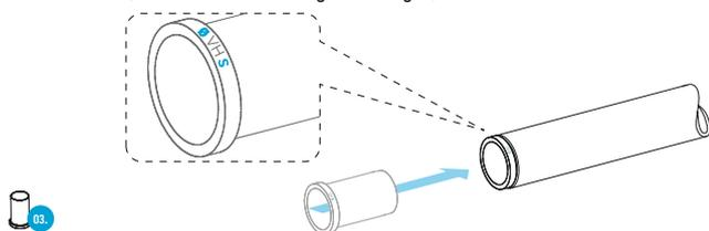
**2** Vor dem Auftragen des LOKPREPs (05) den Stutzen (06) bis zum inneren Anschlag auf das Rohr schieben. Korrekte Einstecktiefe auf dem Rohr markieren (04).
