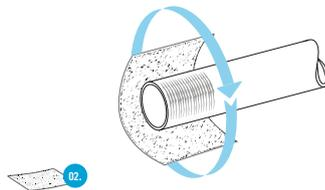
**!** Ermitteln der Rohrwandstärke  $S$  und des Rohraußendurchmessers  $\varnothing$  mittels Rohrkenzeichnung oder Messschieber.
