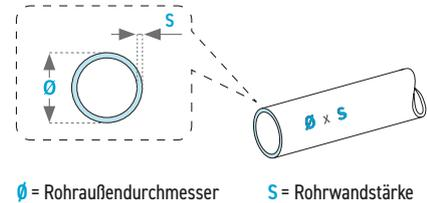
**1** Einsetzen der dem Rohraußendurchmesser  $\varnothing$  und der Rohrwandstärke  $S$  entsprechenden Verstärkungshülse (03) in das Rohrende. Bei Kältemitteln mit einem Betriebsdruck unter 25 bar kann auf den Einsatz von Verstärkungshülsen verzichtet werden (z. B. bei R134a Fahrzeugklimaanlagen).
