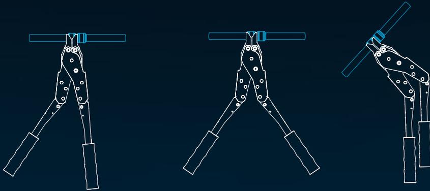
Unsere patentierten Handmontagezangen wurden speziell für die LOKRING Montage entwickelt. Sie benötigen nur ein Werkzeug, da Sie die Montagebacken schnell und einfach wechseln können. Durch die beidseitig abgewinkelten Handgriffe ist die MZ-V auch bei Arbeiten im Motorraum flexibel einsetzbar.
