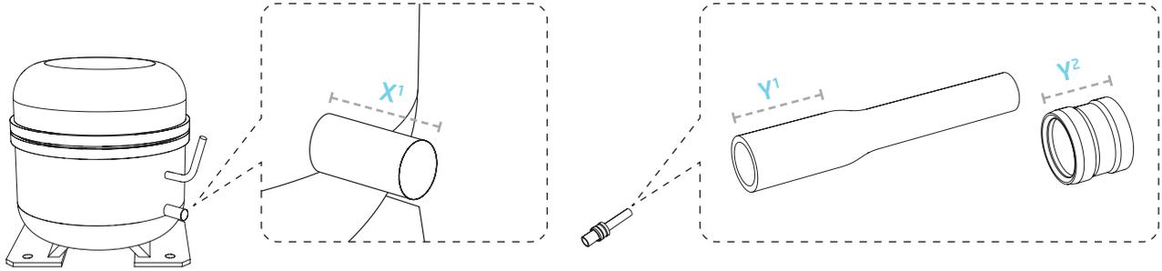
**2** Kompressorstutzen ( $X^1$ ) durch Drehbewegungen mit Schleiflein (02) reinigen, um Lackrückstände und andere Verunreinigungen zu beseitigen.
