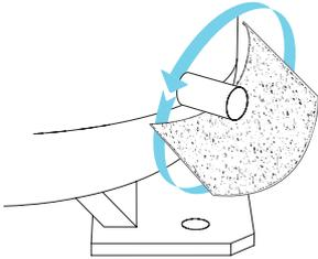
**3** LOKPREP 65G (03) bis zur Schnittkante des Kompressorstutzens ( $X^1$ ) auf den gesamten Rohrfumfang auftragen. Aushärtezeit des LOKPREP 65G (03) beachten.
