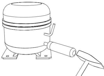
**6** LOKRING Verbindung gemäß der LOKRING Montageanleitung für Montagetyp 00 auf [www.vulkan.com](http://www.vulkan.com) durchführen.
