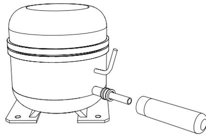
**5** Mit einem Hammer (07) auf das NAV Montagewerkzeug (06) schlagen bis der LOKRING der NAV Verbindung (04) am Kompressorgehäuse (01) anliegt.
